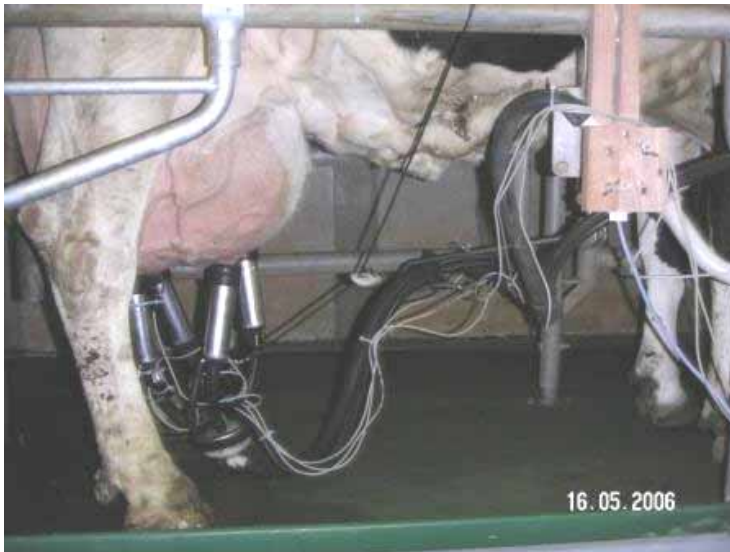
Figuur 1 In melkinstallatie ingebouwde meetapparatuur voor de MelkProcesMonitor
