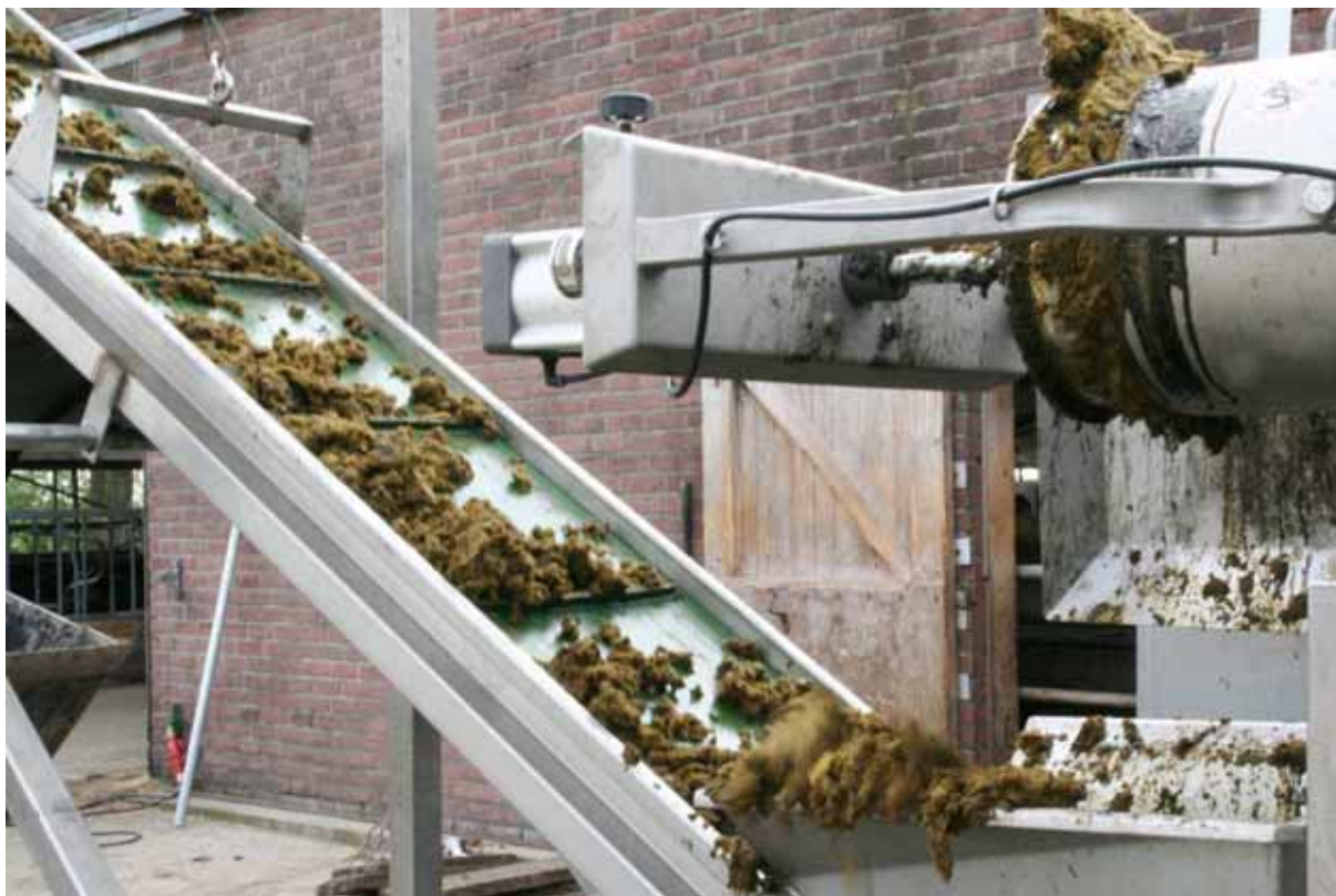
Schroefpersfilter (vijzelpers) zoals toegepast in het project 'Beter benutten door dik en dun'.
