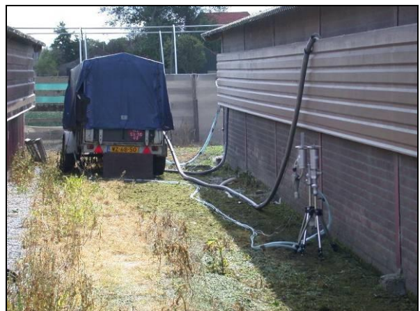
Meting van de ingaande stallucht
