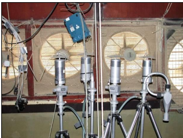
Meting van de uitgaande stallucht
