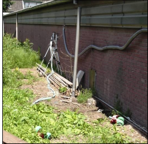
Meting ingaande lucht onder winddrökkap
