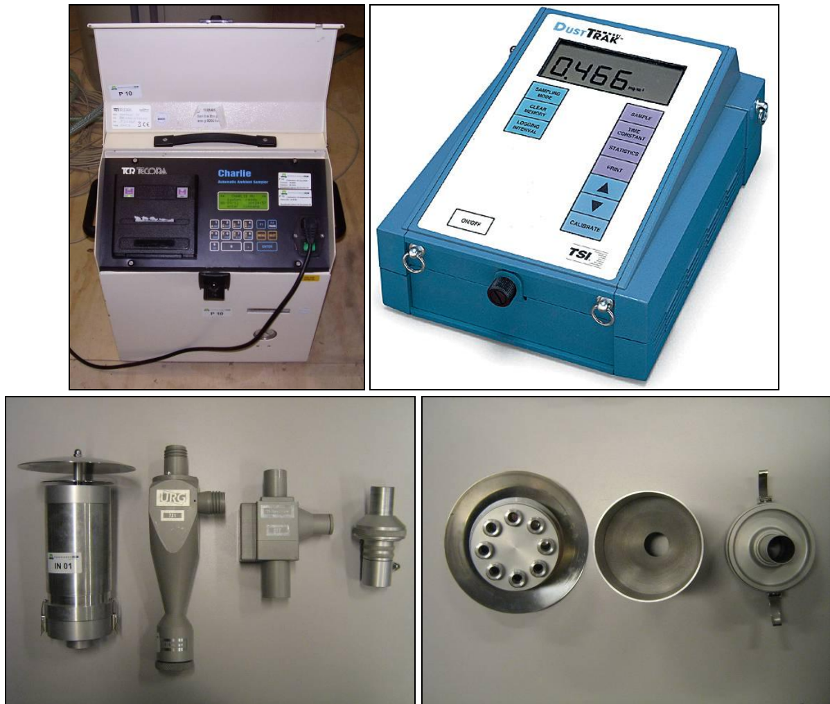
Figuur 1 Monsterrapparaat voor PM10 en PM2,5. Linksboven: de 'constant flow' monsternamepomp. Rechtsboven: de DustTrak model 8520 voor optische en continue metingen van het verloop in PM10 concentratie. Linksonder (van links naar rechts): inlaat, PM10 cycloon, PM2,5 cycloon en filterhouder. Rechtsonder (van links naar rechts): de constructie van de inlaat
