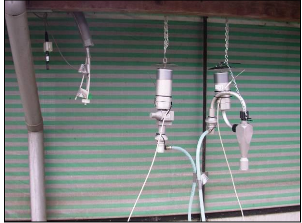
Detailfoto van de meting van de ingaande lucht
