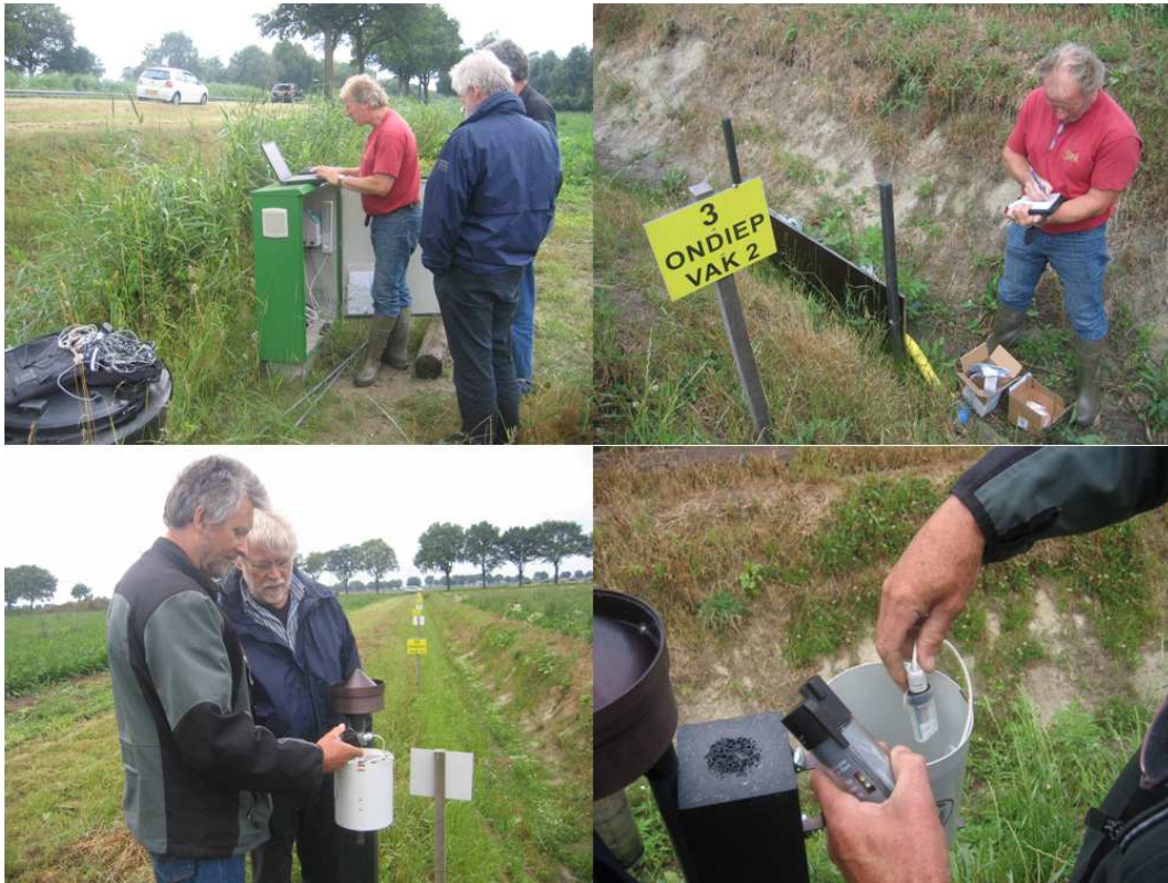
Fotocollage 15 Van linksboven naar rechtsonder, achtereenvolgens: (i) uitlezing en controle van de pomp-debietmeetinstallatie, (ii) verwisselen van Sorbisense cartridges ('Sorbicells'), (iii) inspectie van de regenmeter, en (iv) uitlezen van geregistreeerde neerslag.
