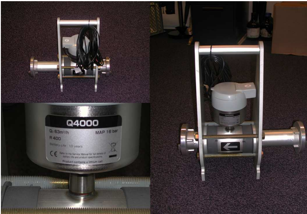
Afbeelding 8 Elektronische debietmeter, geselecteerd voor gebruik op proeflocaties van waterschap 'Brabantse Delta'
