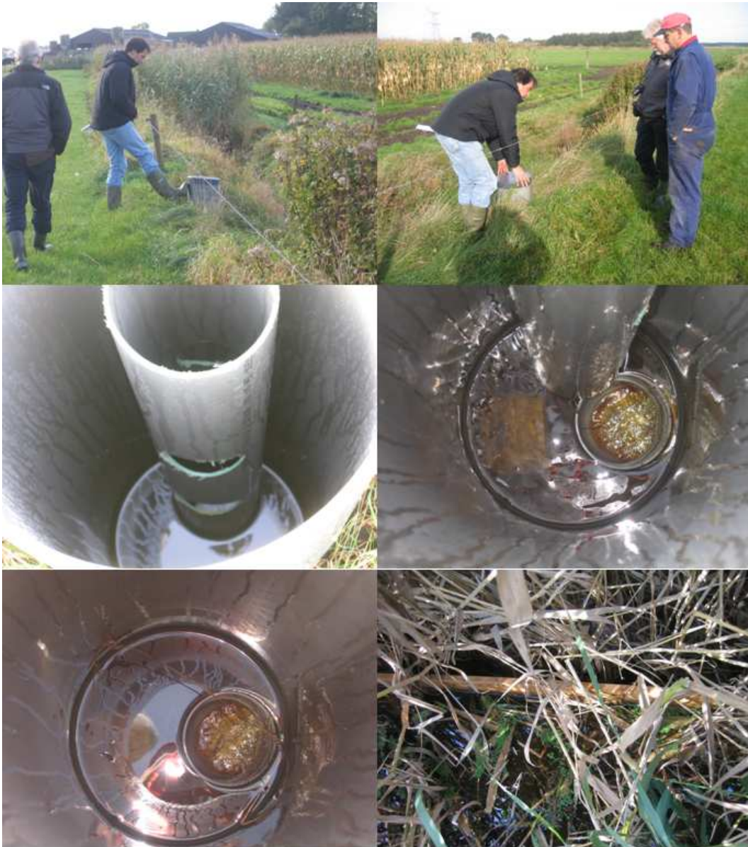
Fotocollage 30 Impressies veldbezoek proeflocatie 'Moerstraten'; van linksboven naar rechtsonder, achtereenvolgens: (i) losschoppen putdeksel, (ii) verwijderen putdeksel, (iii) zicht op pijp met twee ontwateringsdiepten, (iv) put inwendig 1, (v) put inwendig 2 en (vi) stuwteje in perceelssloot is overwoekerd en nauwelijks zichtbaar
