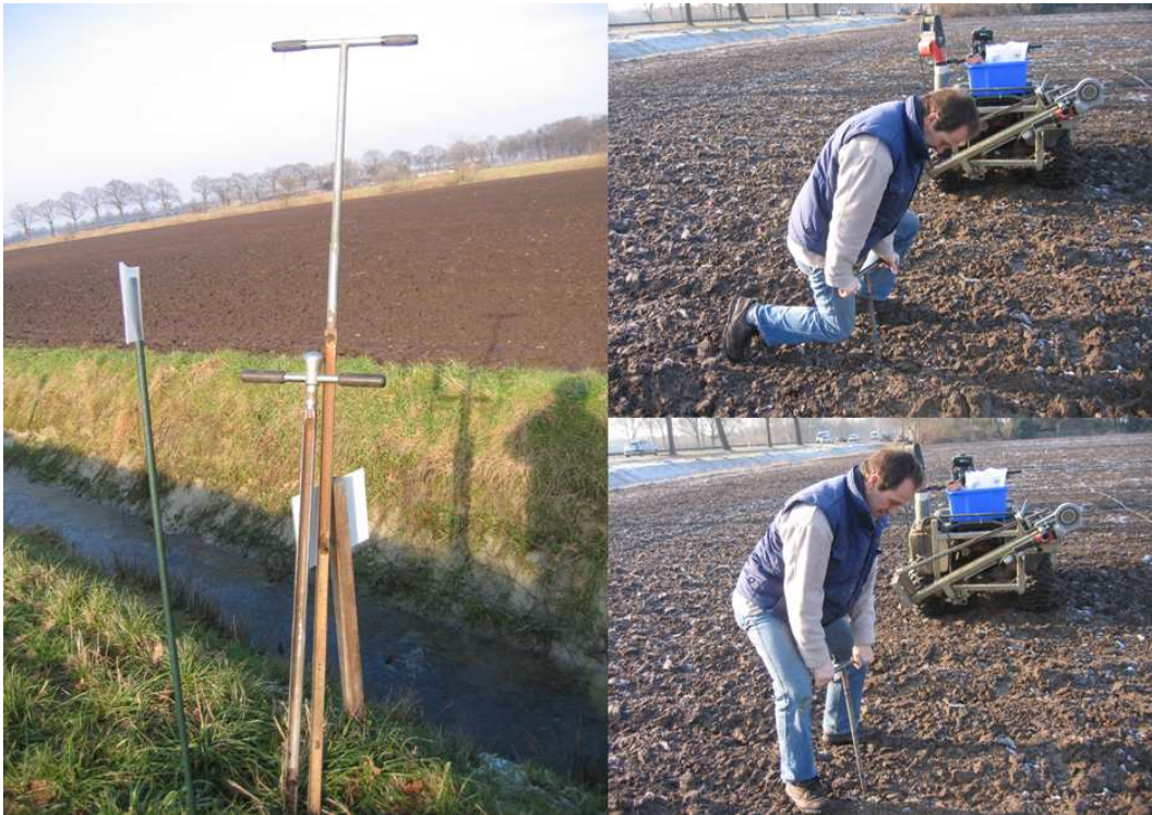
Fotocollage 23 Handmatig steken van bodemmonsters op proeflocatie Ospel in februari 2009. Linksonder: handgutsen met diverse afmetingen; rechts: bemonstering met de hand
