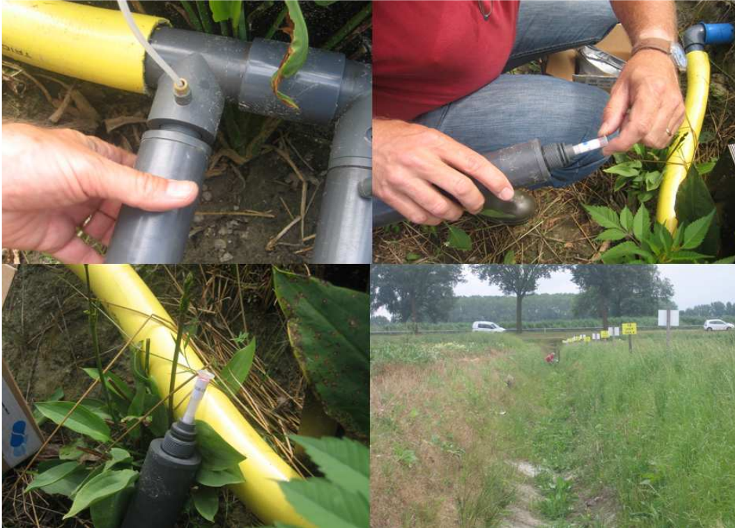
Fotocollage 21 Impressie van Sorbisense meetopstellingen bij drain 3 en drain 10 op proeflocatie Ospel (4)
