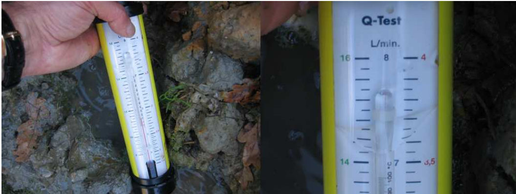
Fotocollage 8 'Q-Test' debietmeter. Door deze onder een waterafvoerende drain te houden, kan direct het debiet worden afgelezen, en de watertemperatuur. Gehannes met emmers, stopwatches etc. is overbodig geworden, en er wordt een enorme tijdwinst geboekt
