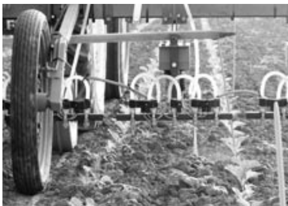
De WeedIt, een machine voor onkruidherkenning en selectieve bespuiting. Foto: Rommie van der Weide, PPO-agu.
