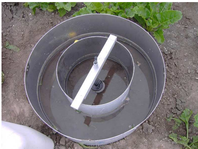
Figuur 5. Meting van de infiltratiesnelheid van water in de bodem
