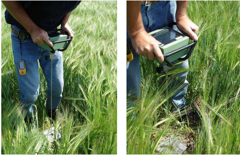
Figuur 4. Meting van de indringingsweerstand van de bodem met een (digitale) penetrometer
