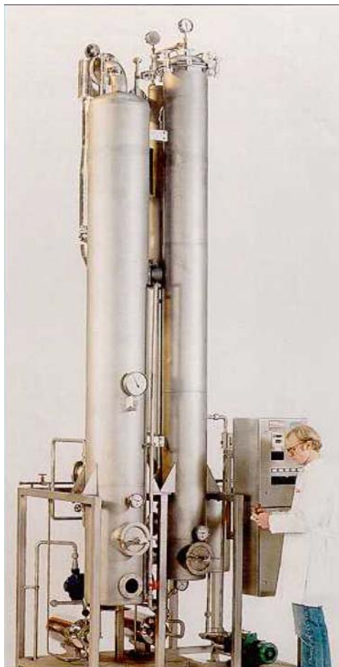
Figuur 10 Een pilot plant indamper voor op kleine schaal (tot 2000 kg input per uur) (Bron: GEA Process Engineering)
