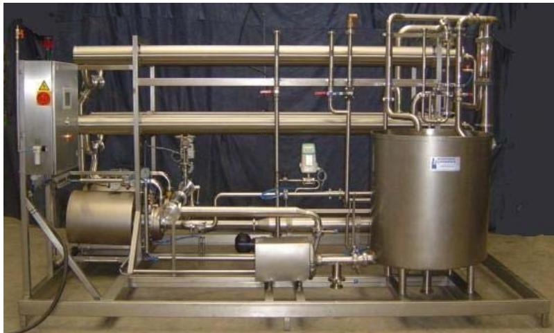
Figuur 7 RO installatie voor toepassing op de boerderij (Bron: Machinehandel Lekkerkerker )
