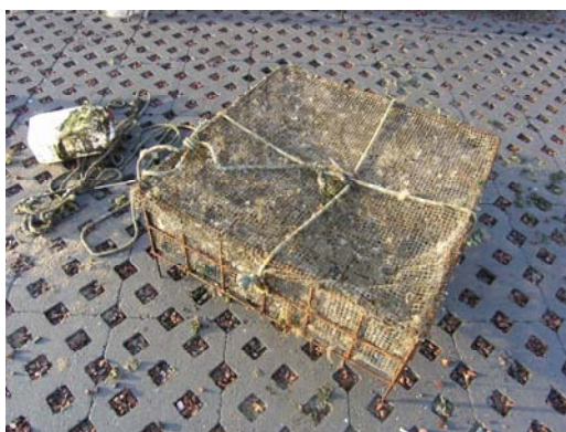
Figuur 6: Bovenaanzicht van een kooi waarin mosselen zijn geplaatst voor het uitvoeren van onafhankelijke metingen
