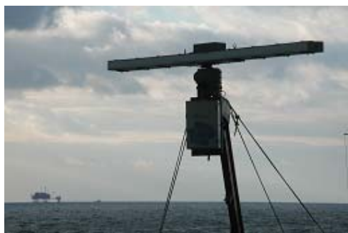
Figuur 17 Foto van de SHIRA (navigatieradar) antenne. De radar was (tijdelijk) geïnstalleerd op het RWS-DNZ schip de "ARCA". Doel van de campagne was het lokaliseren en volgen van olievlekken op zee
