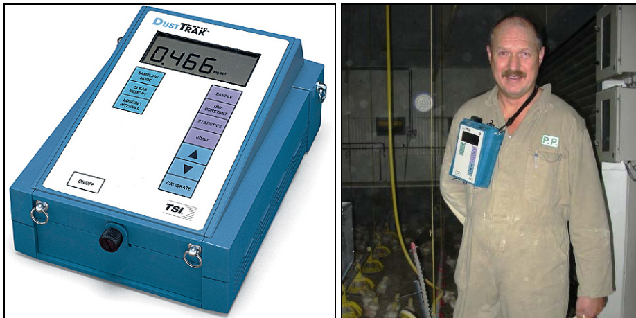
Figuur 4 Links: de DustTrak model 8520. Rechts: het meten van de persoonlijke stofbelasting.
