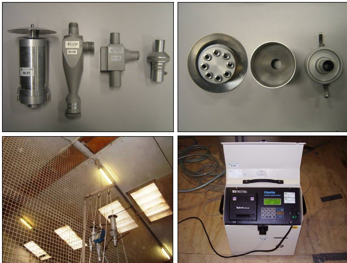
Figuur 5 Monsteraanrapparaatuur voor PM10 en PM2,5. Linksboven (van links naar rechts): de inlaat, PM10 en PM2,5 cyclonen en filterhouder. Rechtsboven: de constructie van de inlaat van de cycloon. Linksonder: positie van monstername in de stal, ca. 1,5-2,0 m onder de nok. Rechtsonder: een 'constant flow' monsternamepomp.
