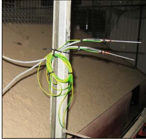
Figuur 9 Twee temperatuursensoren waarvan de metalen huls d.m.v. twee koperdraden is geaard aan een metalen balk van het volièresysteem
