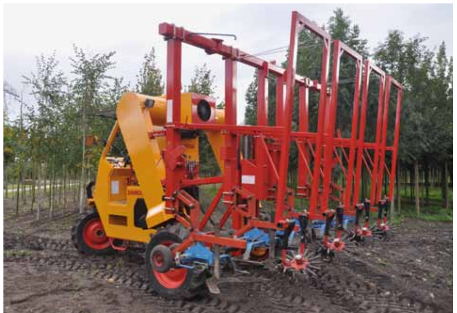
Met de Multitrike (Damcon) kunnen 3 hele en 2 halve rijen worden bewerkt
