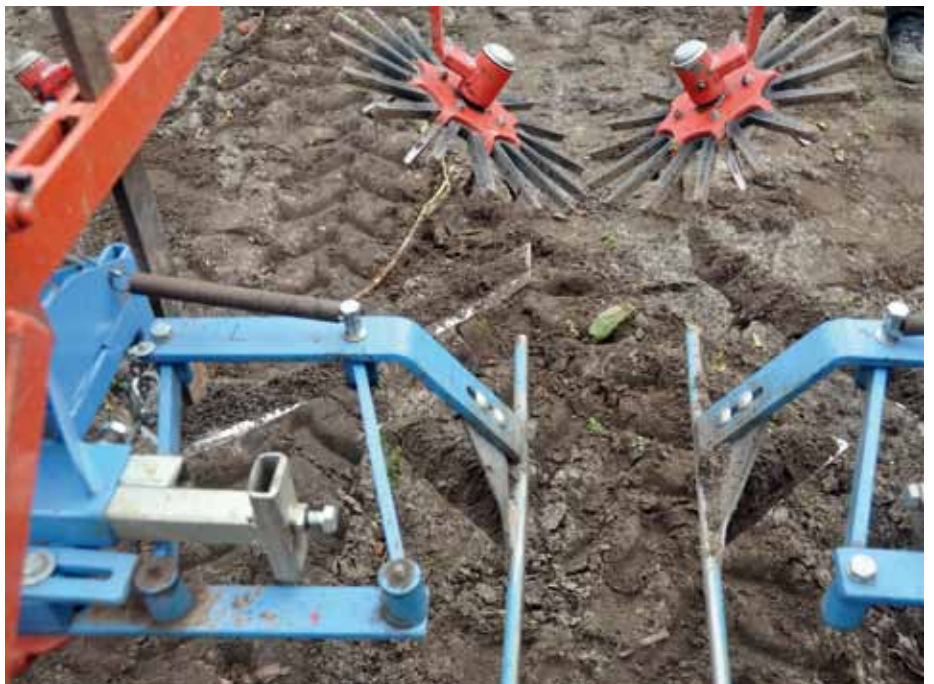
Detail van de schoffels van de Multitrike
