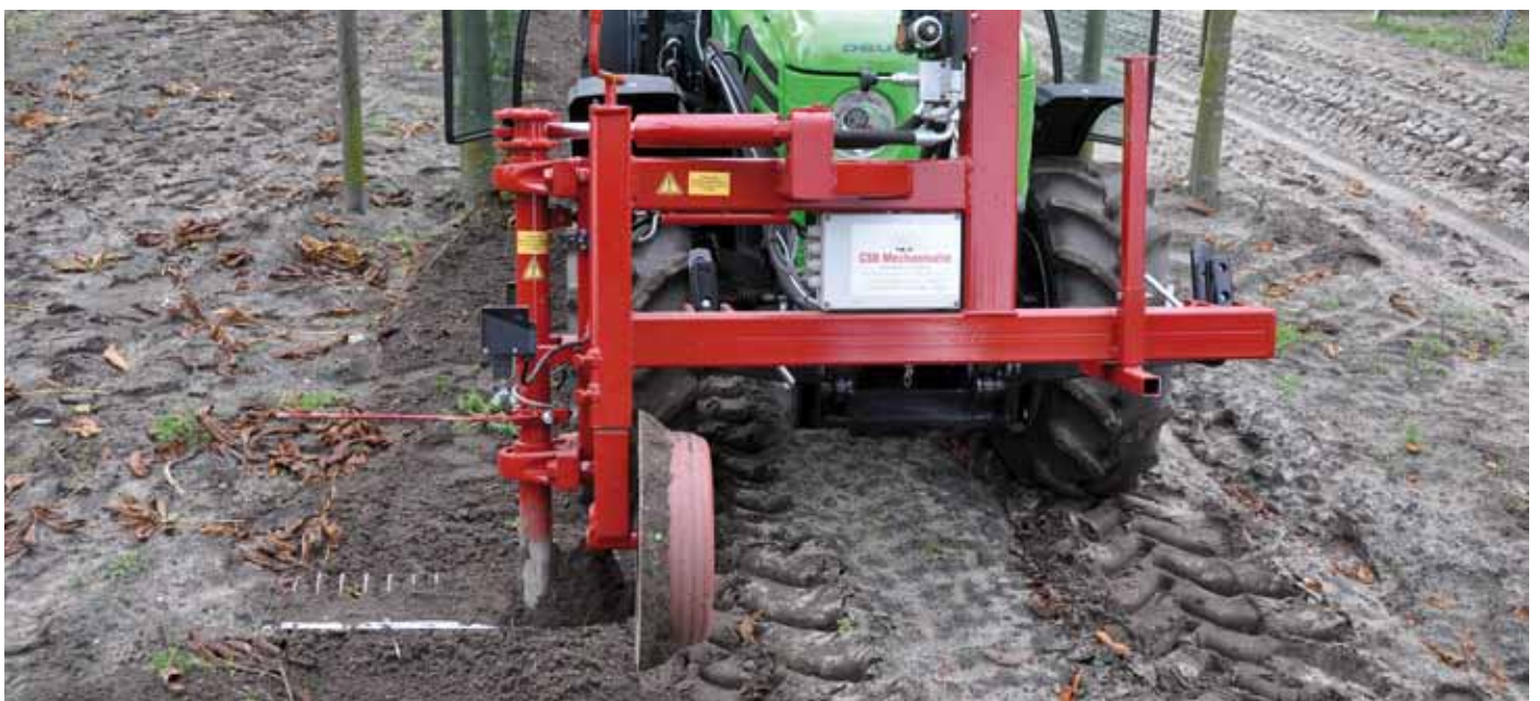
Een infrarood signaal zorgt dat het schoffelmes op tijd terugklapt en de boom niet raakt (CBS mechanisatie)
