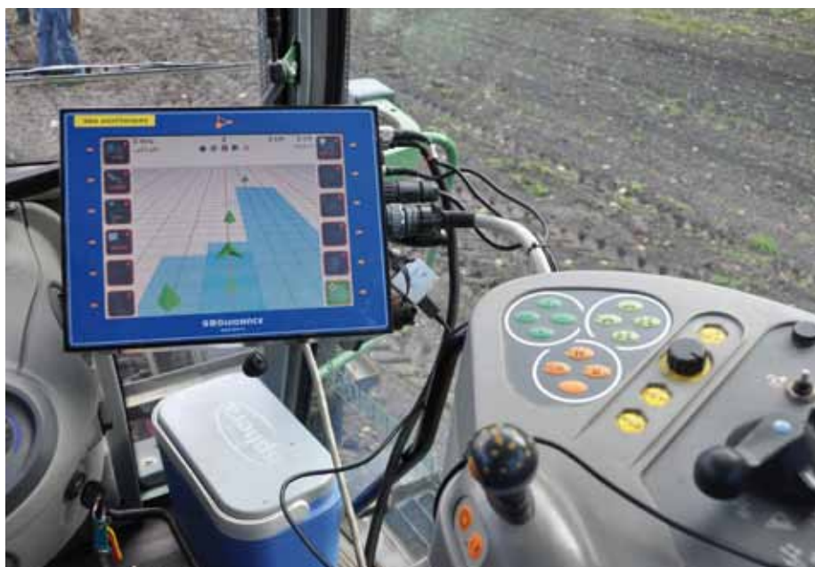
Schoffelen met GPS - RTK maakt het mogelijk bewerkingen tot \pm 1 à 2 cm nauwkeurig uit te voeren
