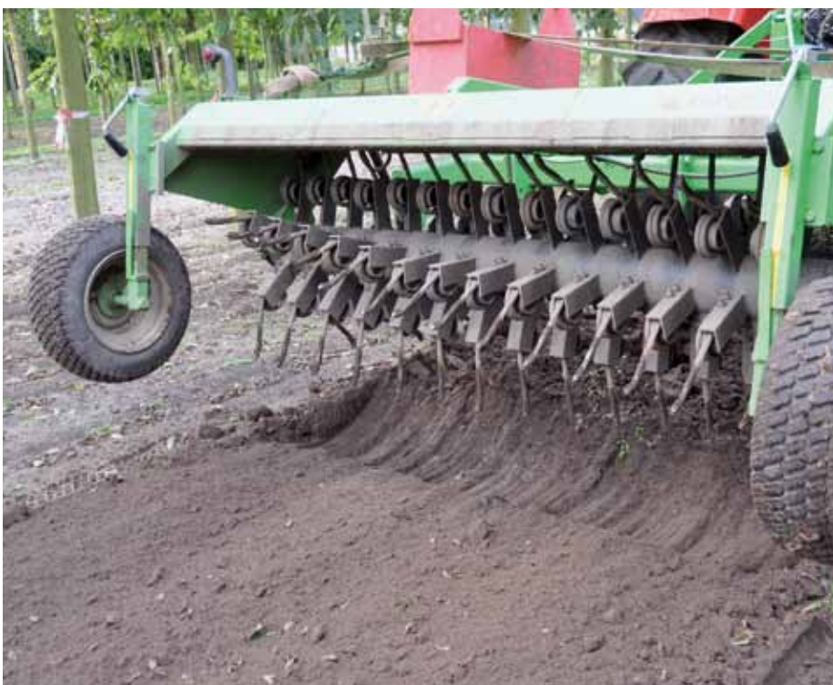
De Kvik Up trekt de grond tot op een diepte van 40 cm los
