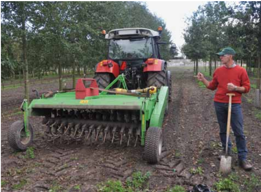
De Kvik Up brengt de wortelonkruiden naar het maaiveld
