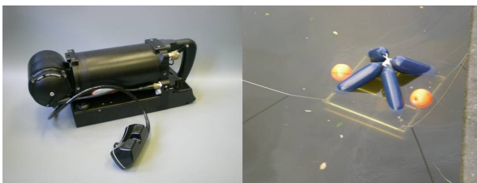
Foto 3.3. De DIDSON (links) en het frame waarmee de DIDSON in het water hangt (rechts).
