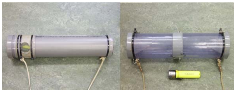
Figuur 2: De twee typen lichtvallen die gebruikt zijn tijdens de glasaalintrek in 2010.
