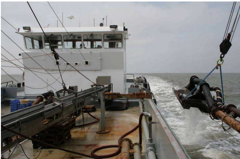
Gecharterd kokkelvaartuig "Ye42" met rechts in beeld de aangepaste zuigkor (foto IMARES – Hans Verdaat).
