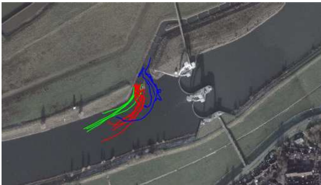
Figuur 9. Lokstroom bij Driel zoals gemeten met behulp van drijvers bij hoge afvoer (groen) en lagere afvoer (rood en blauw) (figuur uit Schropp, 2010)
