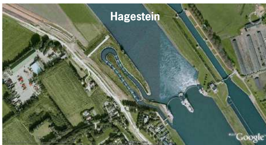
De drie stuw-complexen met vistrappen in omleiding bij Driel, Maurik / Amerongen en Hagestein.
