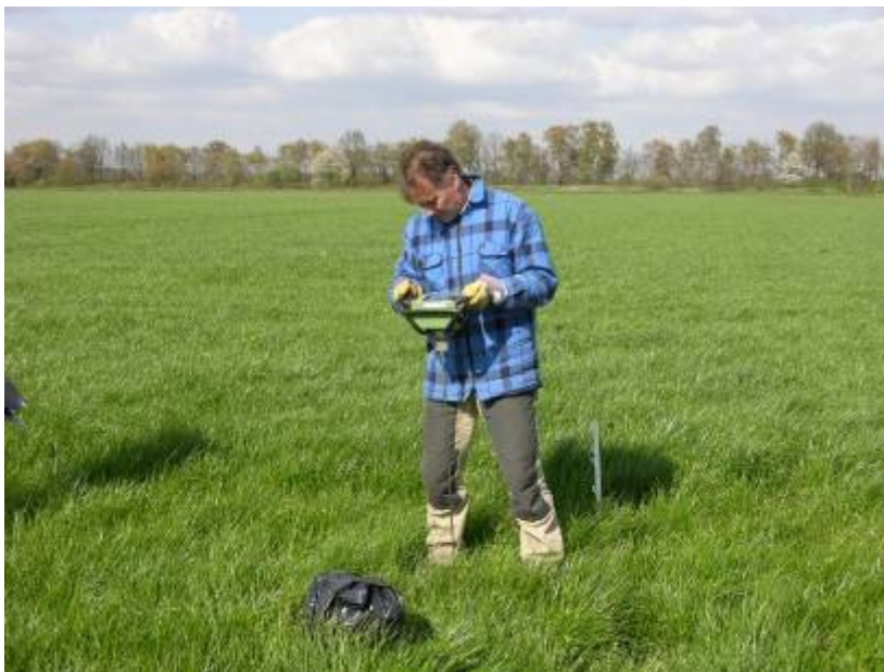
Meten van de indringingsweerstand met de penetrologger
