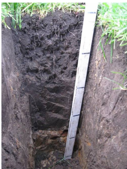
Vaststellen van dikte donkere laag en diepte van beworteling
