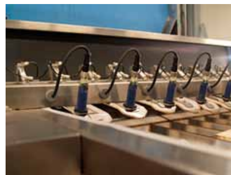
Deze machine sorteert de aardappelen volautomatisch
