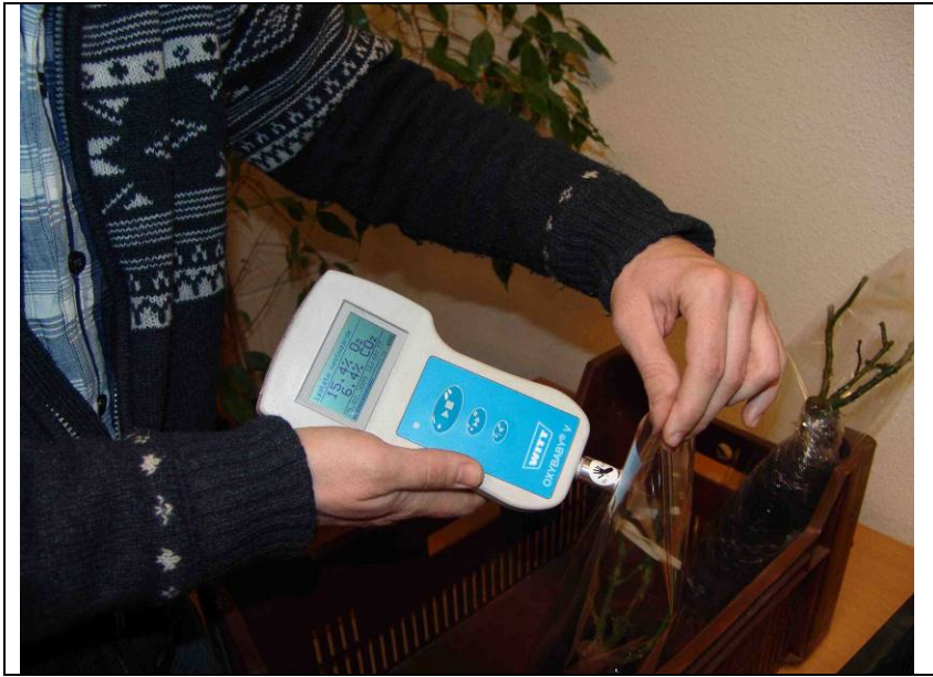
Figuur 9. De gassamenstelling in de zakken werd in de proeven wekelijks gemeten.
