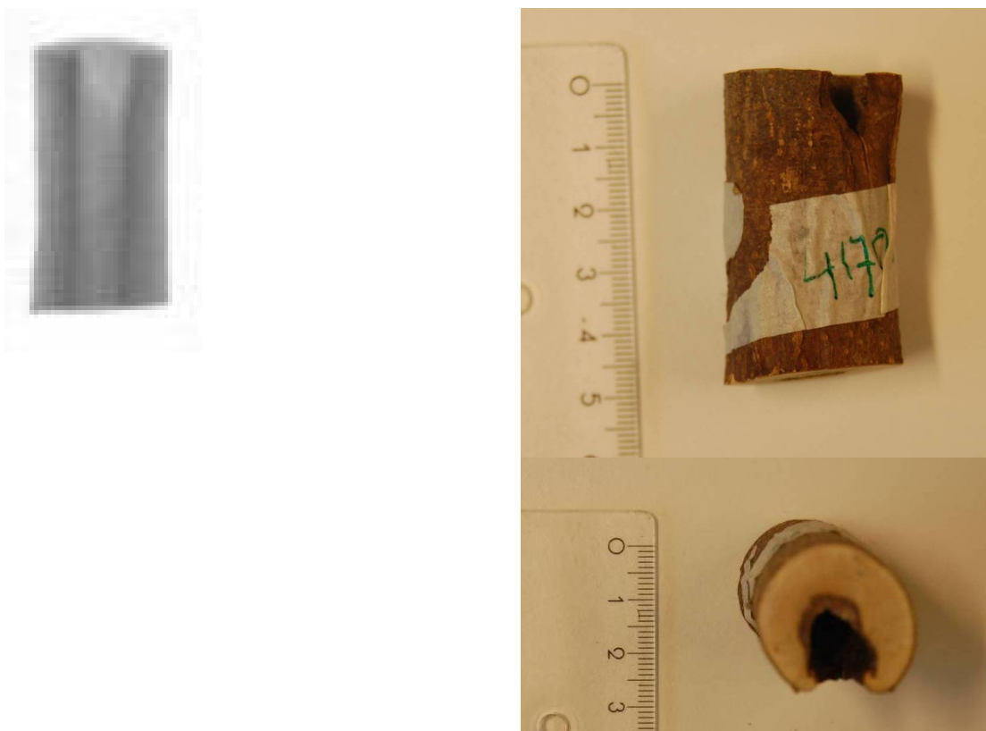
Figuur 10. Links: röntgen opname met duidelijk zichtbaar de scherpe overgangen in grijswaarden op de plaats van de boorgang. Rechts: foto's van het voor- en bovenaanzicht van het bijbehorend houtstuk met duidelijk zichtbaar de boorgang (Xray apparatuur type 1).
