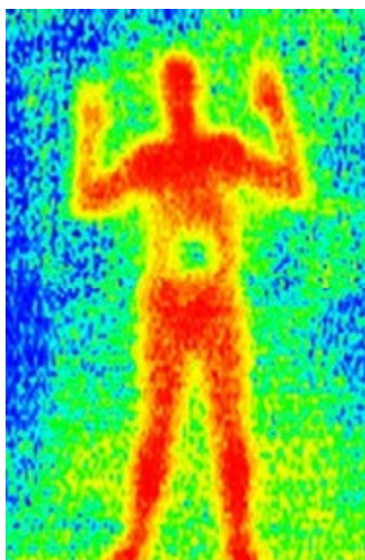
Figuur 4. TerraHertz opname van een man die iets probeert mee te smokkelen onder zijn hemd ( http://www.thruvision.com , Noorderlicht, 'Verkenning in het duister, TerraHertz technologie opent de ogen').
