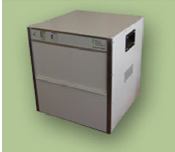
Figuur 8. De Fluorcam (Photon System Instruments, Brno, Czech Republic) voor het opnemen van chlorofyl fluorescentie beelden.
