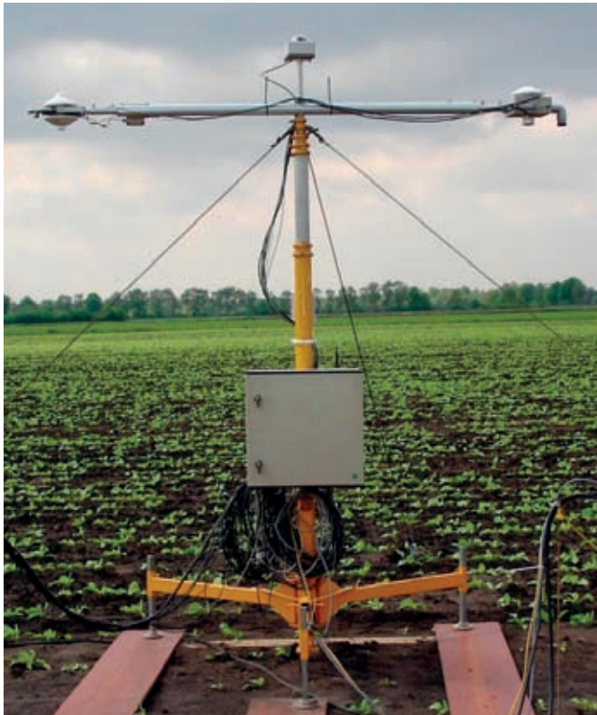
FIGUUR 2 FOTO VAN EEN AUTOMATISCH WEERSTATION (LINKS) EN EEN EDDY-CORRELATIE STATION OP MEETLOCATIE VREDEPEEL
