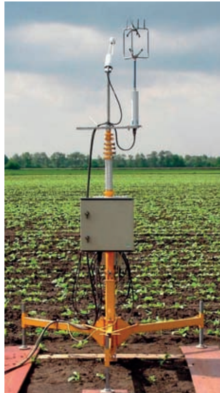
FIGUUR 2 FOTO VAN EEN AUTOMATISCH WEERSTATION (LINKS) EN EEN EDDY-CORRELATIE STATION OP MEETLOCATIE VREDEPEEL
