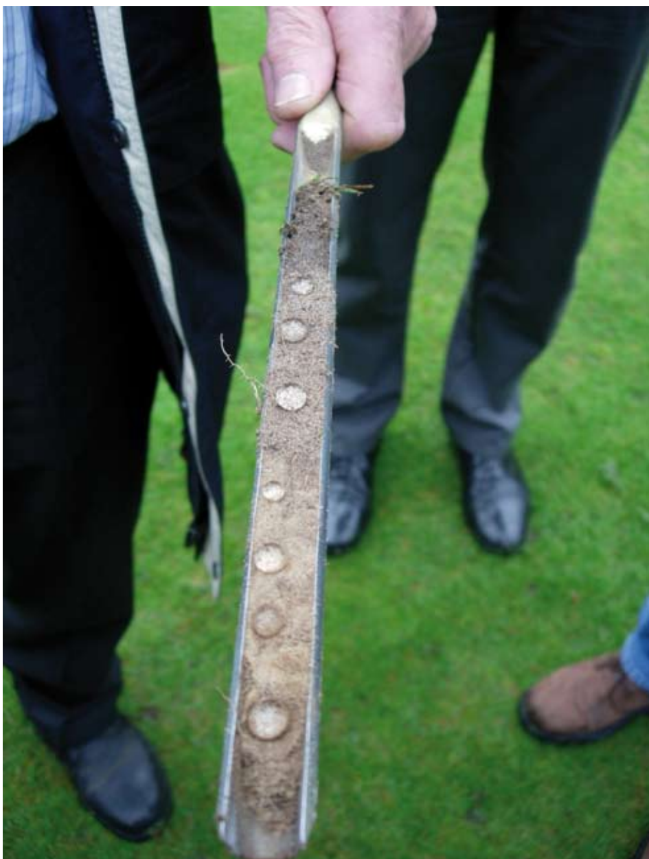
Het vaststellen van de waterafstotendheid met behulp van een smalle steekboor.
