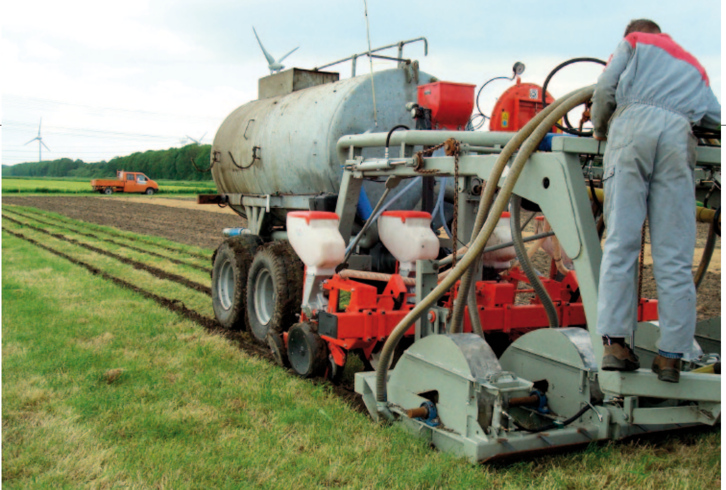
Veehouder Henk Pol op zijn zelfontwikkelde strokenfrees, waarmee hij in het gras smalle stroken grond bewerkt voor de zaai en bemesting van maïs.
