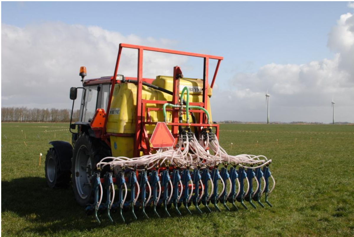
Afbeelding 1 Proefveldmachine voor de toediening van vloeibare meststoffen
