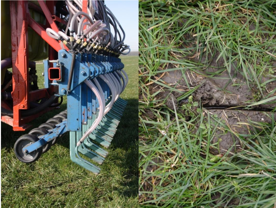
Afbeelding 2 Kouter van proefveldmachine en sleuf in graszode
