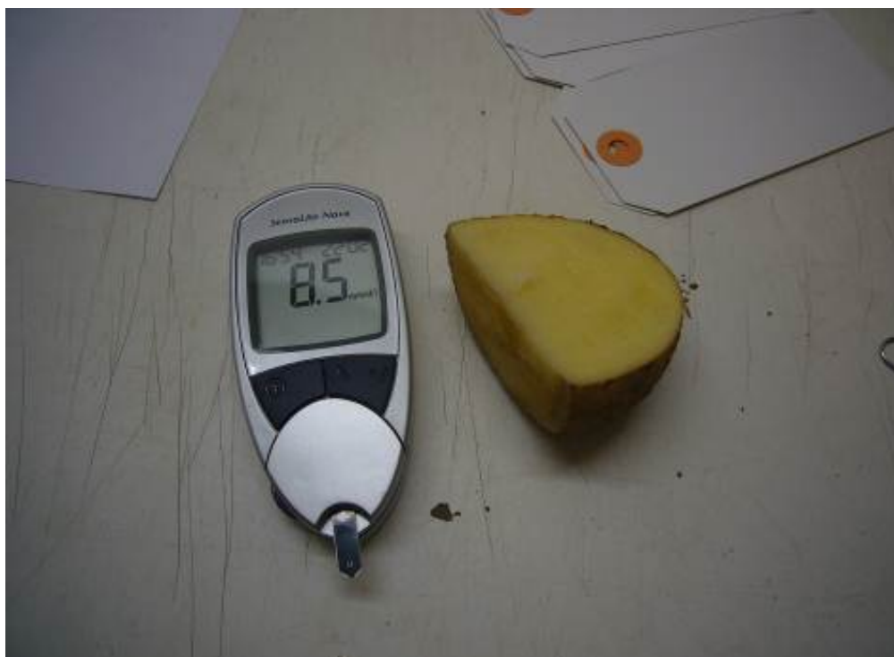
Figuur 15. Na aanbrenge van het sap geeft de meter een waarde in millimol.
