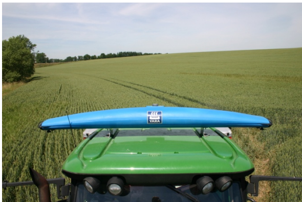
Afbeelding 2 Yara N-sensor bovenop een tractorcabine gemonteerd
