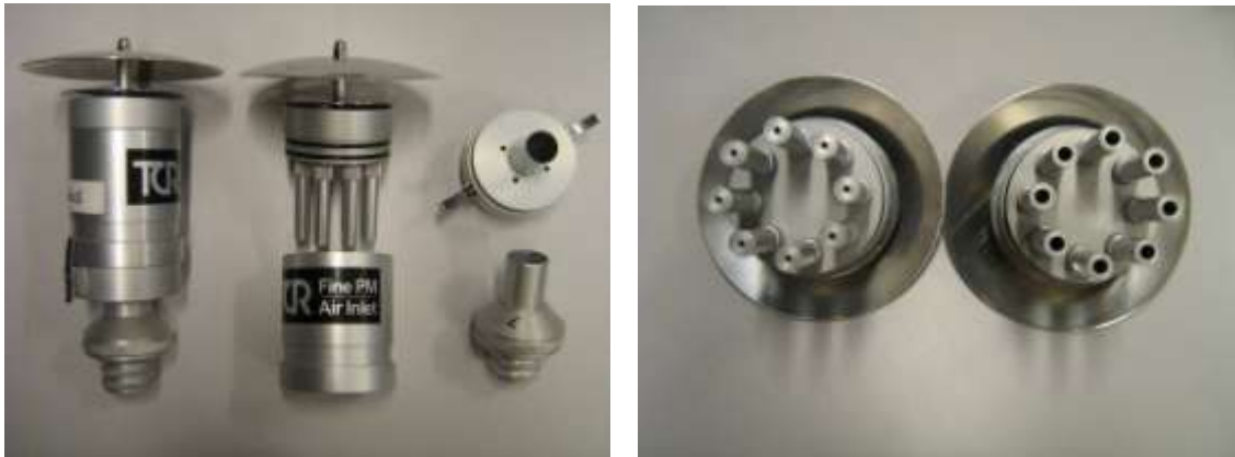
Figuur B1 Links de complete meetset en rechts het verschil in de openingen van de luchtinlaten boven de impactieplaat (grotere openingen voor PM10)
