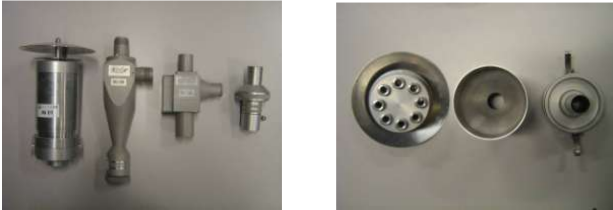
Figuur B2 Links de complete meetset met twee verschillende cyclonen (langwerpig is voor PM10) en de filterhouder en rechts de binnenkant van de luchtinlaat deze is voor beide stoffracties gelijk
