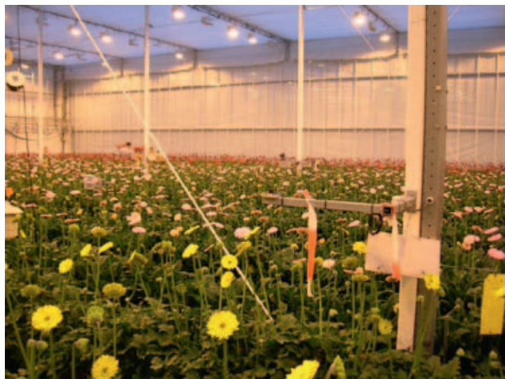
Figuur 2. De PAR sensor van het IC zit vast gemonteerd aan een staander van de kas. De GrowWatch is te zien gemonteerd aan de staander achter de PAR sensor. De GrowWatch heeft 2 PAR sensoren.
