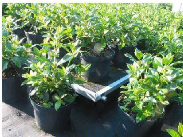
Figuur 1. Weegstelsel als meet- en sturingsinstrument voor het vochtgehalte in de pot.
