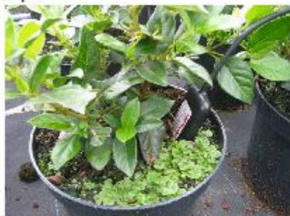
Figuur 2. WET-sensor als sturingsinstrument voor het vochtgehalte in de pot en meetinstrument van de EC-waarde en temperatuur.
