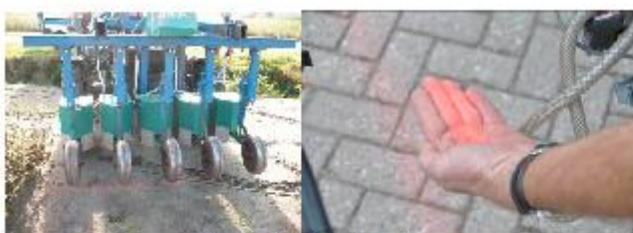
Sensorgestuurde rijenspuit voor gebruik in bos- en haagplantsoen.
