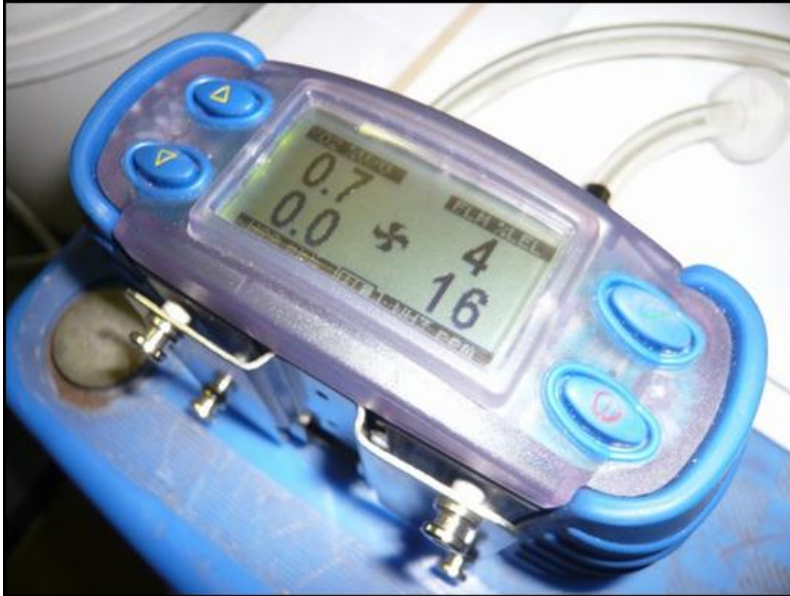
Foto 2 Handmeter voor gasmetingen van O 2 , H 2 S, NH 3 en CH 4
