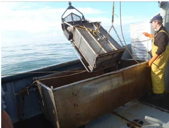
Figuur 3 De ingezette bodemschaaf aan boord van de BRA7
