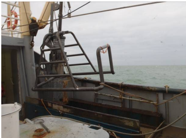
Figuur 4 De ingezette boxcorer en opvangslede aan boord van de BRA7
