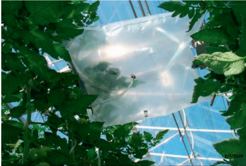
Figuur 5.1. Labelling van tomatenblad met ^{13}\text{CO}_2 .
