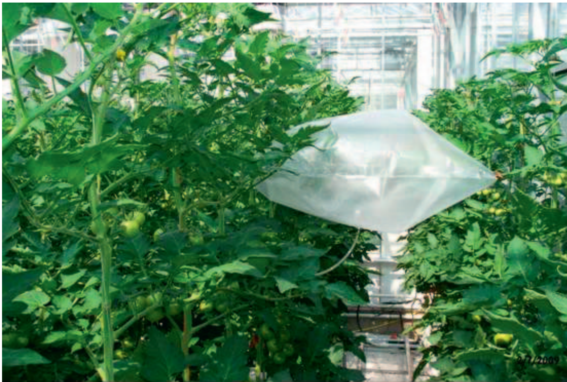
Figuur 5.3. 'On-site' labelling van tomatenblad met de stabiele isotoop ^{13}\text{C} in de vorm van ^{13}\text{CO}_2 .
