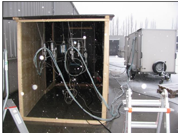
Meting uitgaande lucht in het verlengde meethuisje
