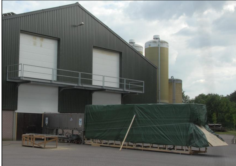
Detailfoto van het ionisatiefilter en meetopstelling 2, ingepakt in waterdicht groen zeil. Rechts is de uitstroomopening onder de windkap zichtbaar.
