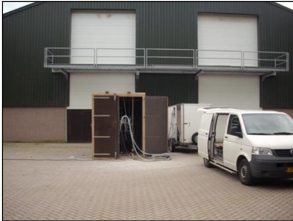
Meetopstelling 1a – Uitgaande meting bij stal 1 in het originele houten meethuisje van de leverancier
