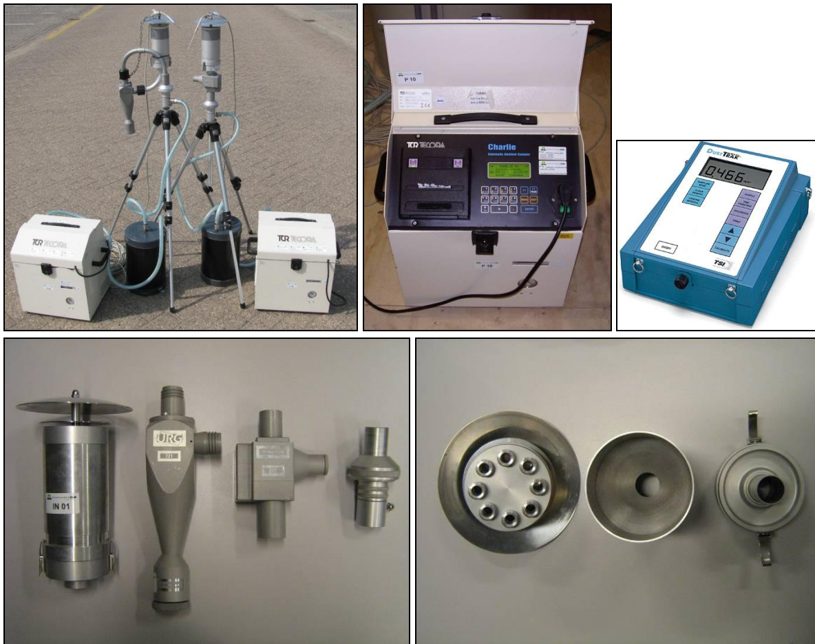
Figuur 1 Monsterapparatuur voor PM 10 en PM 2,5 . Linksboven: een set apparatuur voor gravimetrische meting van PM 10 (linker driepoot) en PM 2,5 (rechter driepoot). Middenboven: detailfoto van de 'constant flow' monsternamerpomp. Rechtsboven: de DustTrak model 8520 voor optische en continue metingen van het verloop in PM 10 concentratie. Linksonder (van links naar rechts): inlaat, PM 10 cycloon, PM 2,5 cycloon en filterhouder. Rechtsonder: de constructie van de inlaat
