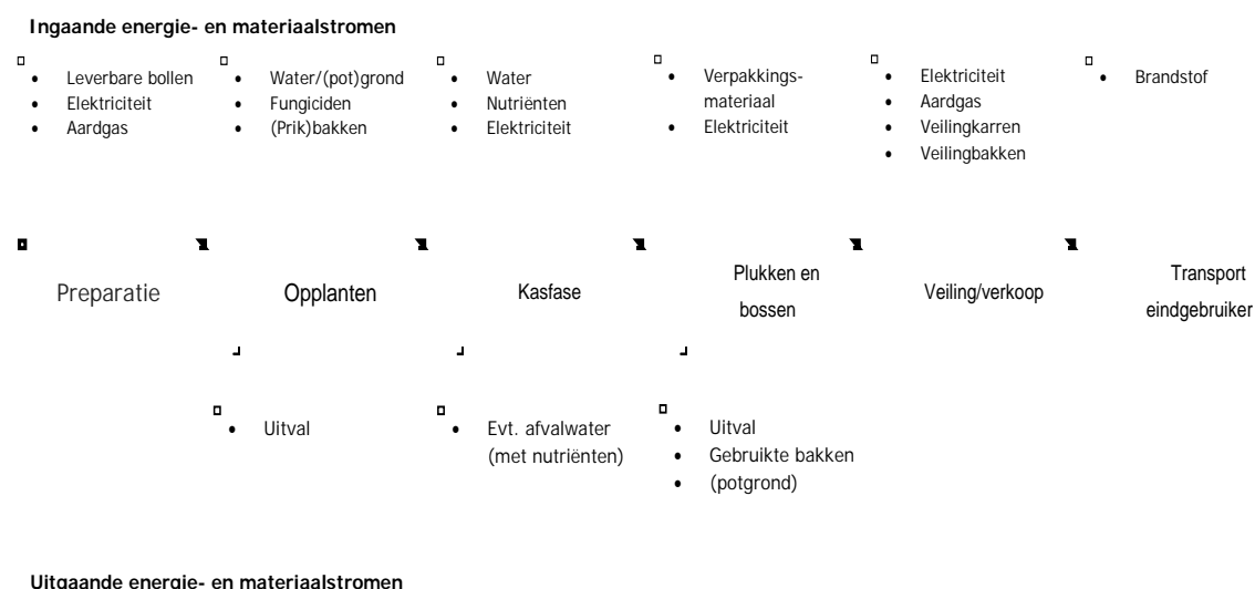
Figuur 1: Productiestappen met de belangrijkste energie- en materiaalstromen in de broeierij
