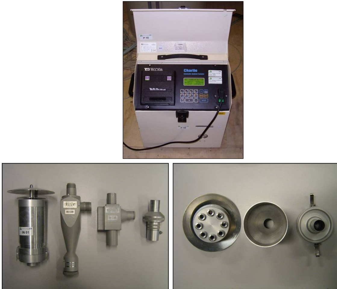
Figuur 2 Monsterapparatuur voor PM10 en PM2,5. Boven: de 'constant flow' monsternamepomp. Linksonder (van links naar rechts): inlaat, PM10 cycloon, PM2,5 cycloon en filterhouder. Rechtsonder: de constructie van de inlaat
