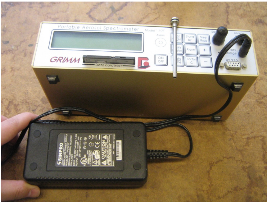
Figuur 3 Monsternameapparatuur voor deeltjesgrootteverdeling, de stofspectrometer van Grimm
