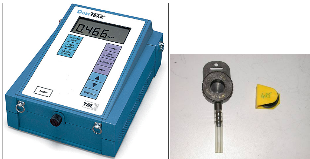
Figuur 1 Links: De DustTrak model 8520 voor optische en continue metingen van het verloop in PM10 concentratie. Rechts: Monsterapparatuur voor totaalstof, met links op de foto de IOM monsterkop met aanzuigleiding naar de pomp en rechts op de foto de filterhouder met bescherming voor transport.
