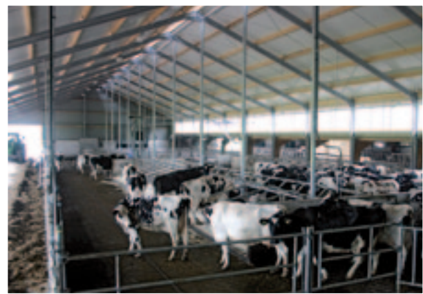
↑ HET DAK VAN DE NIEUWE STAL VAN MTS. PIERIK BEGINT 1,50 METER BOVEN DE GOOT VAN DE OUDE, ZODAT DAAR LICHT EN LUCHT BINNENKOMT.
