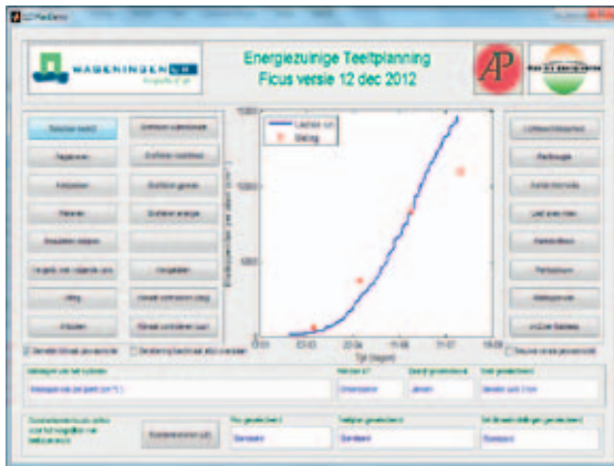
Figuur 3.5. Verloop van het bladoppervlak ( \text{cm}^2 blad/ plant) van Ficus 'Danielle' (zelfde teelt als in Figuur 3.1.). Het waargenomen verloop wordt niet helemaal correct gevolgd door het model omdat bij de berekening de 2 e orde zijscheuten niet expliciet worden meegenomen. Verder houdt het model geen rekening met bladval, wat de overschatting op het eind van de teelt verklaart.
