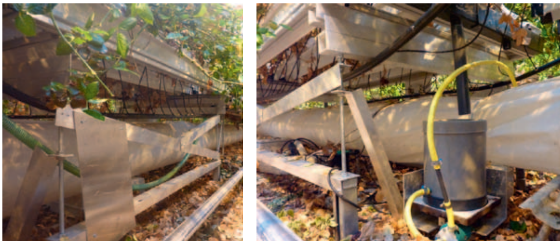
Figuur 3.5. Weegunit met frame waarop loadcells en goten die uitmonden in drainopvang.
