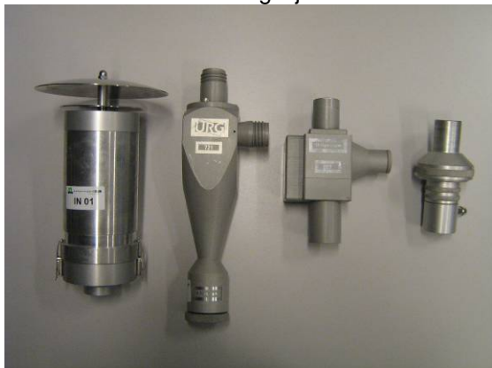
Figuur B2 Links de complete meetset met twee verschillende cyclonen (langwerpig is voor PM10) en de filterhouder en rechts de binnenkant van de luchtinlaat deze is voor beide stoffracties gelijk
