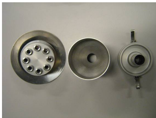
Figuur B2 Links de complete meetset met twee verschillende cyclonen (langwerpig is voor PM10) en de filterhouder en rechts de binnenkant van de luchtinlaat deze is voor beide stoffracties gelijk
