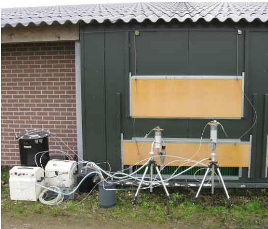
Meetapparatuur luchtinlaat buitenzijde stal
