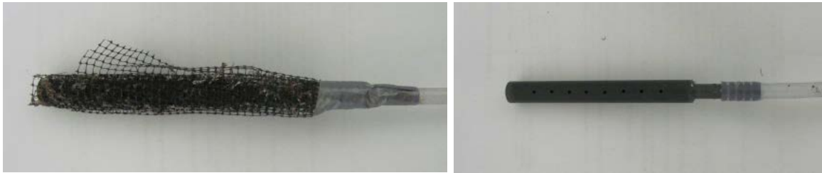
Figuur 4-5: Links een pvc buisje met gaas omwikkeld zoals deze in de compostlagen aangebracht waren en rechts hetzelfde buisje zonder gaas.
