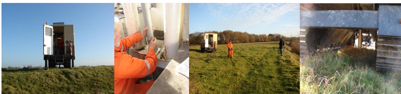
Figuur 2: Het nemen van ongestoorde bodemprofielen met behulp van Begemann boringen.
