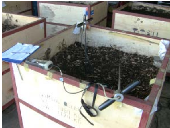
Foto 2 Temperatuursonde (linksboven in reactor), uitleesunit (midden links op rand reactor) en bodemzuurstofsonde (rechtsonder liggend op de rand van een kist)
