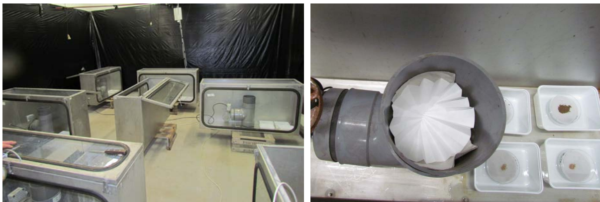
Figuur 20. Opstelling van de proef 'Actellic-ruimtebehandeling in kasten'. Kasten waarin de behandeling werd uitgevoerd (links), de ventilator met het filtreerpapier waar Actellic op werd aangebracht (rechts) en de schaaljes met mijten (rechts).
