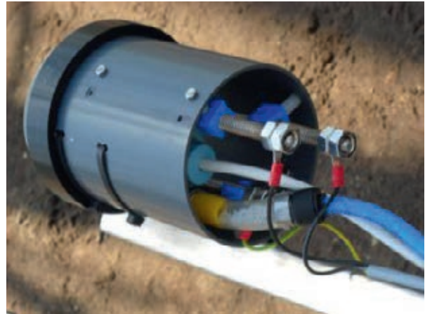
Pompmodule met niveauschakeling.
