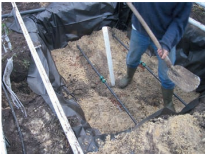
Een eerder model van de lysimeter gemaakt van stoomfolie.
