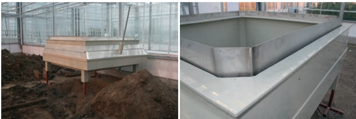
Het prototype van de lysimeter met beweegbare bovenrand, voor de plaatsing in de grond in een kas in Bleiswijk.
