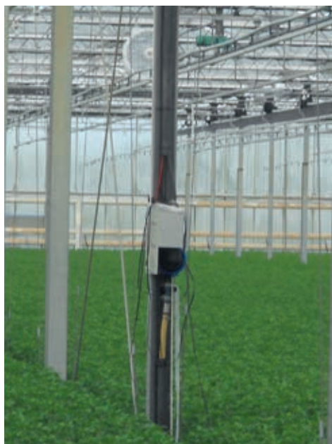
Membraanpomp voor oppompen meetbuis voor drainwater.
