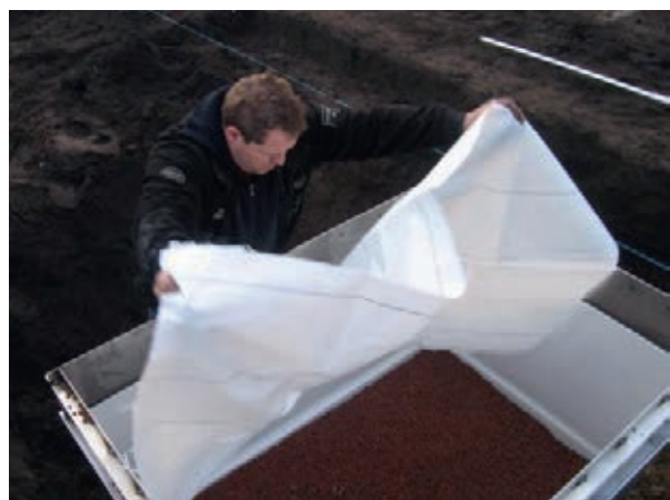
Bodem lysimeter gevuld met kleikorrels en afgedekt met vliesdoek om te verhinderen dat wortels in de laag met kleikorrels dringen.
