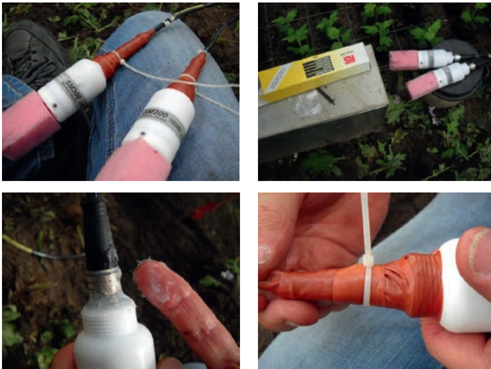
Figuur 19. Aanbrengen van sealing met zuurvrij silicone vet op connectoren van SM300 sensoren.
