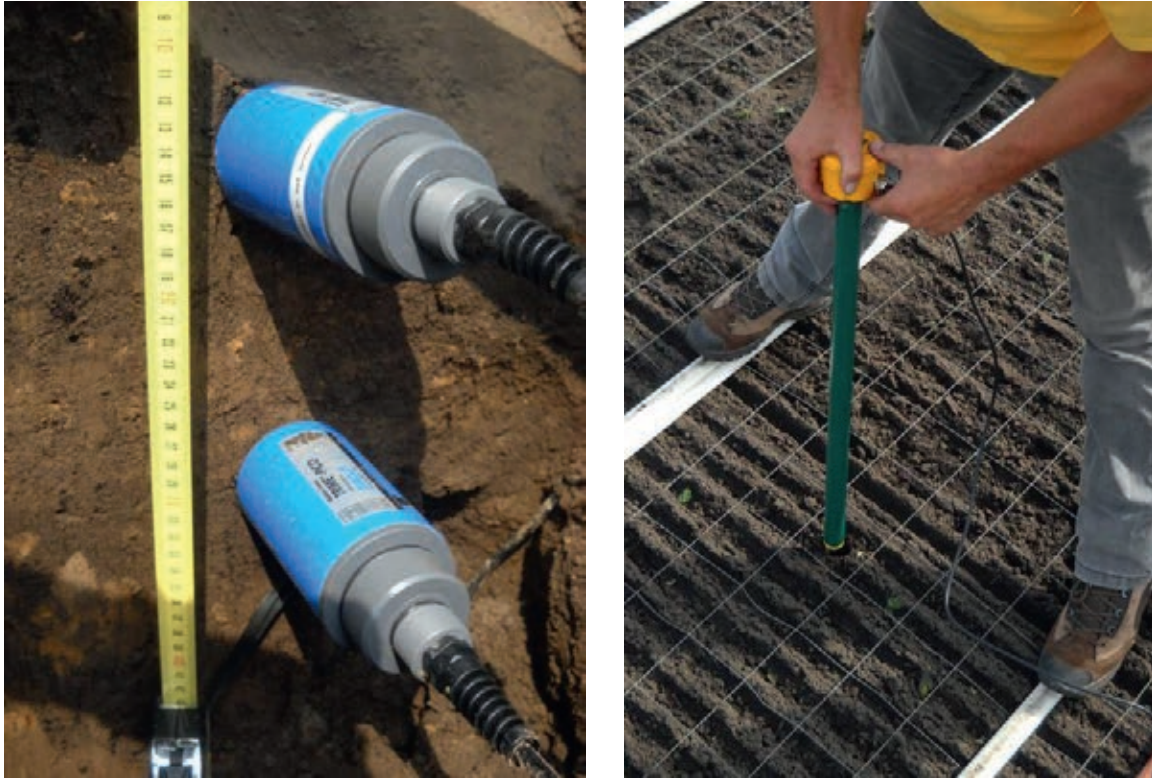
Figuur 27. Losse sensoren (TRIME PICO 64) geplaatst in het verticale profiel (links) en het plaatsen van een prikstok (DACOM).
