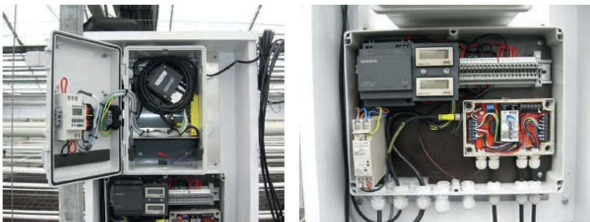
Figuur 10. Data-acquisitie unit GP1 van Delta-T Devices (links) en GSM-modem (rechts).
