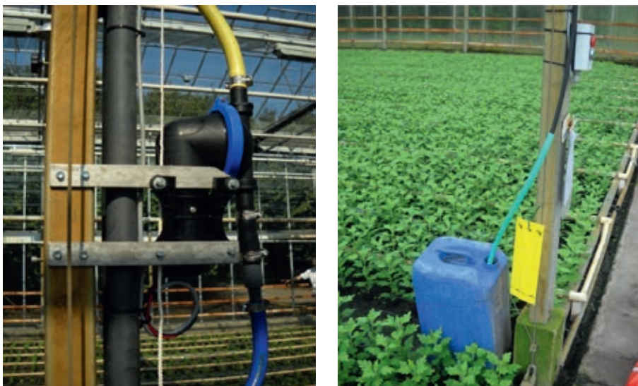
Figuur 4. Drainpomp, bemonsteringsvat, bediening voor een drainpomp.
