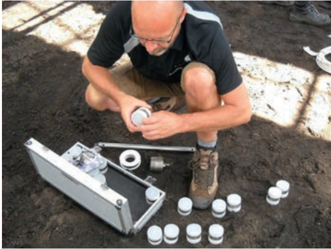
Figuur 28. Grondbemonstering voor bodemtype kalibratie van vochtsensoren.
