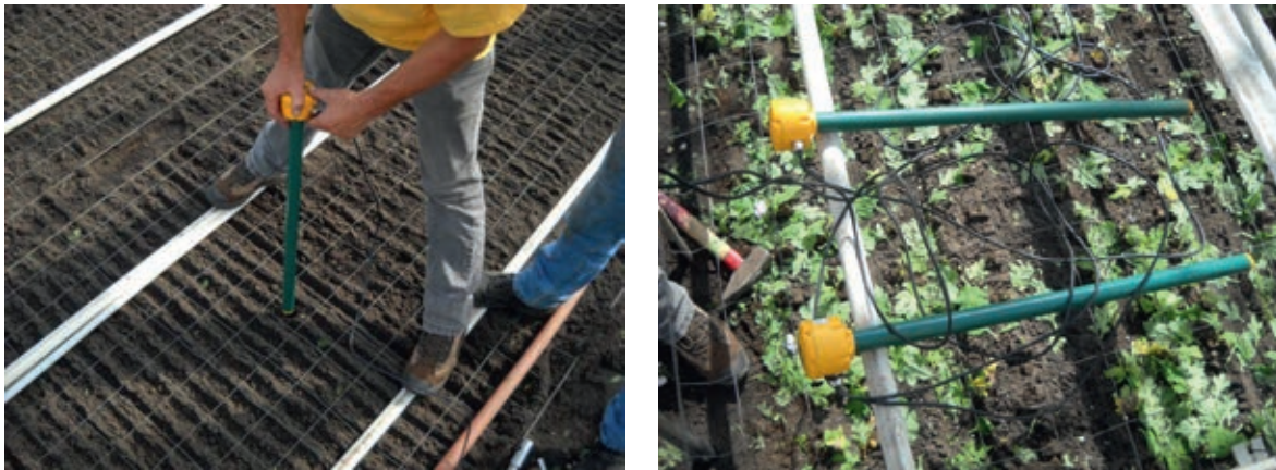
Figuur 22. DACOM prikstok, eenvoudige installatie na voorboren.
