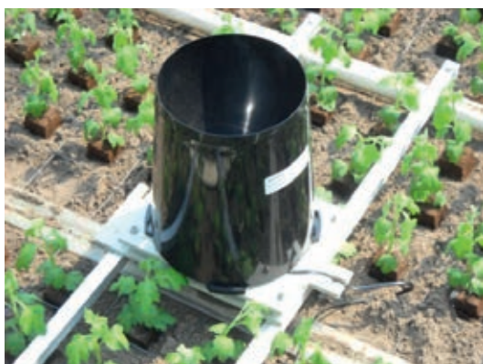
Figuur 25. Regenmeter (DAVIS, Rain Collector II, 7852, zie manual).
