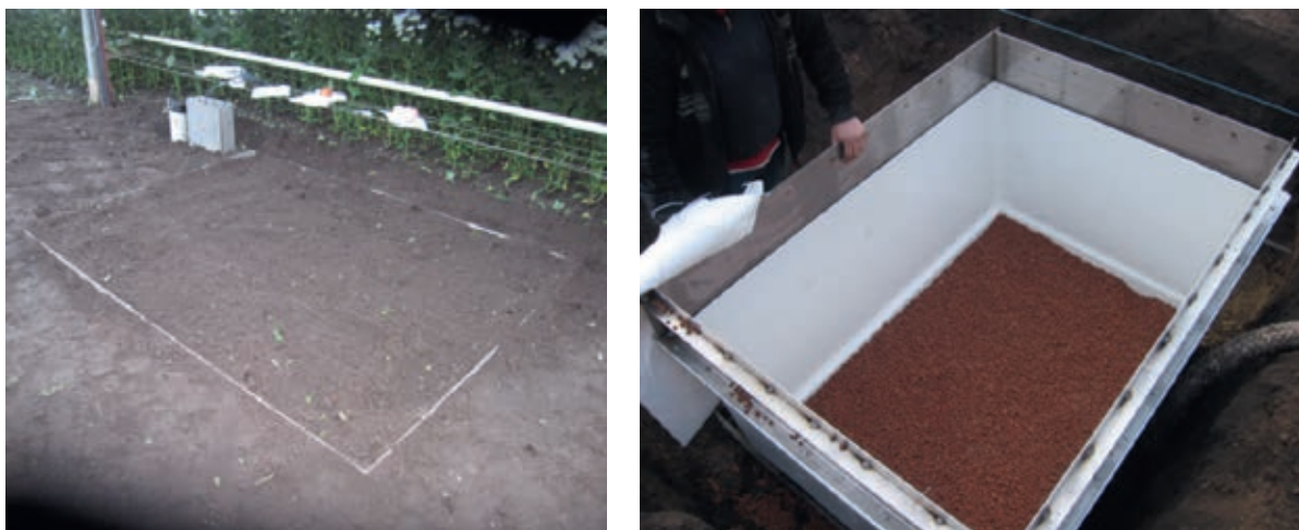
Figuur 3. De lysimeter (optie 0) voor en na plaatsing.
