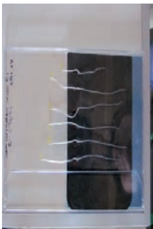
Figuur 22. De alternatieve testmethode met hoes, met een extra laag zaadtestpapier.
