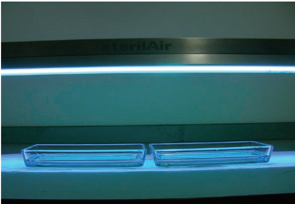
Figuur 1. Meetopstelling met UV lampen.
