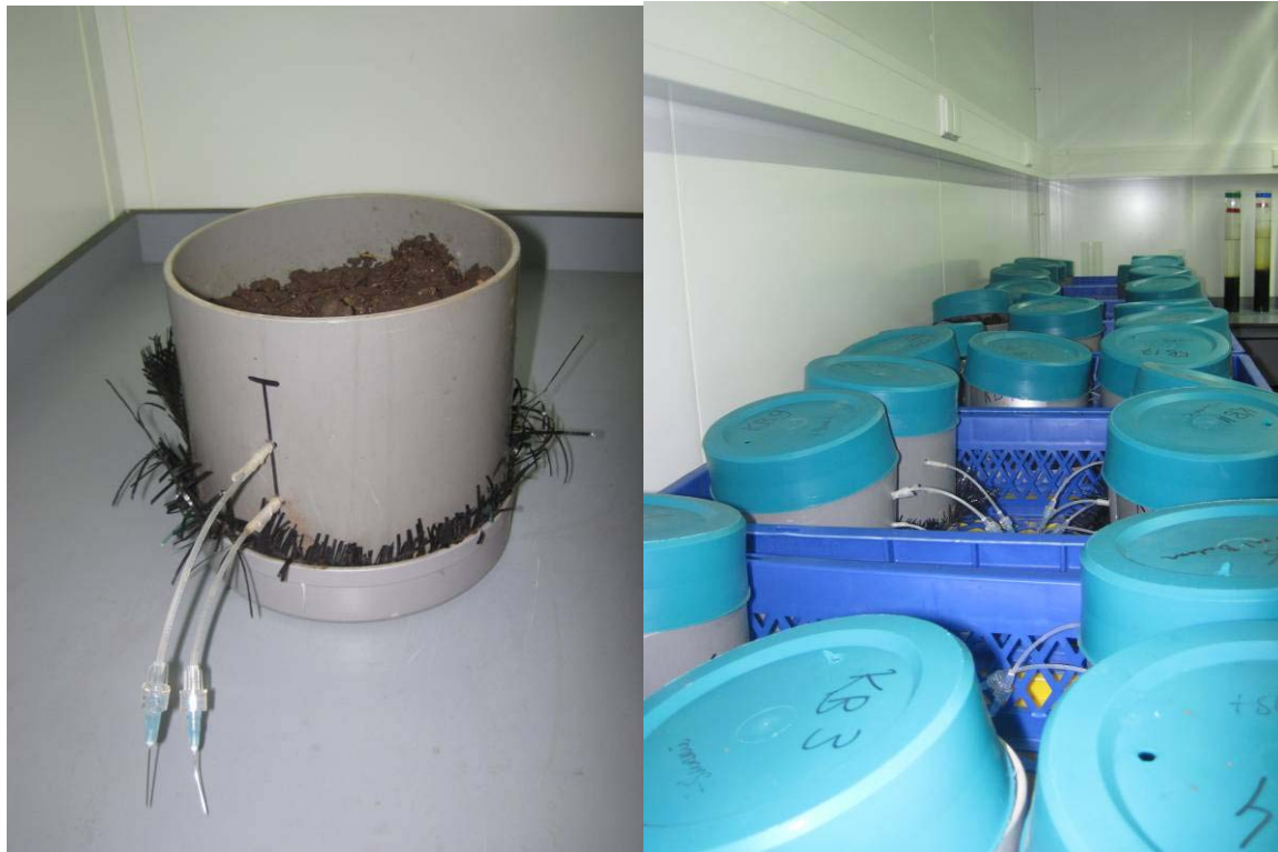
Figuur 4.1. Bodemkolom met rhizons (links), en de proefopstelling in de klimaatkamer (rechts).
